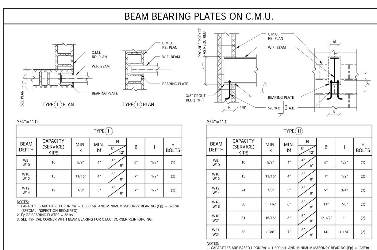
(SPECIAL INSPECTION REQUIRED). 2. Fy OF BEARING PLATES = 36 ksi.
